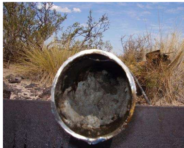
Figura 17 – Muestras de arena en tanques y líneas
