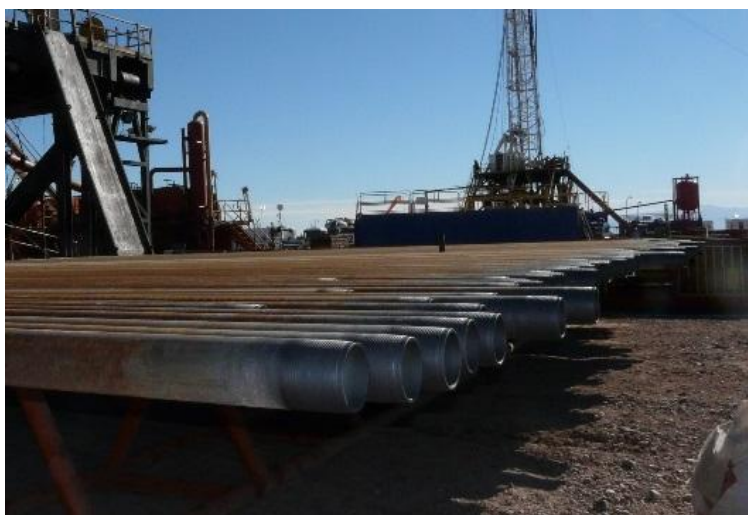
Figura 6: Conexión premium con sello metal-metal y hombro en campo
