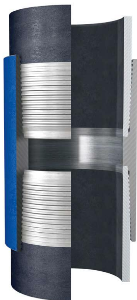
Figura 5: Conexión premium con sello metal-metal y hombro de torque
