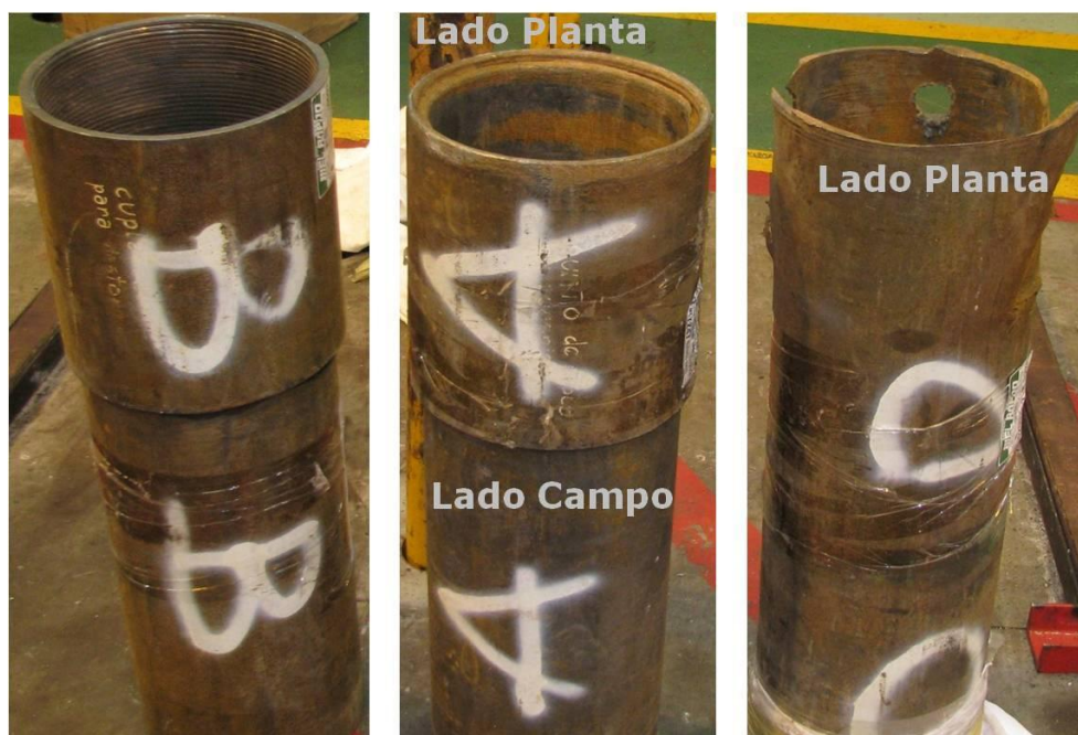
Figura 10: Muestras de columna con falla
