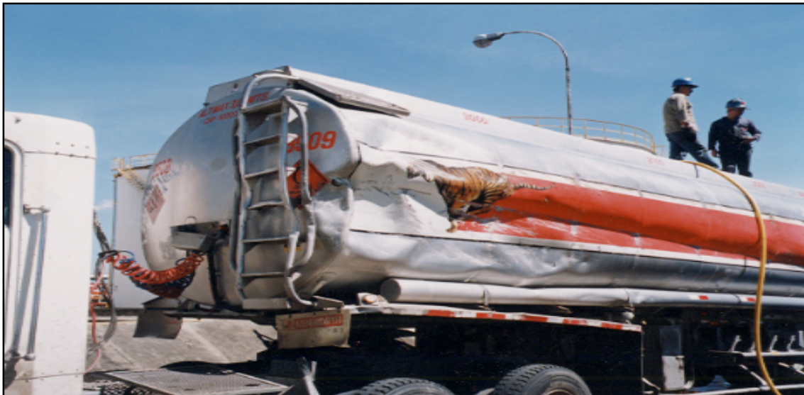
Imagen 1. Vuelco de una unidad en Bogotá, Colombia Transporte de 38.000 litros de gasolina Perdida 0 litros
