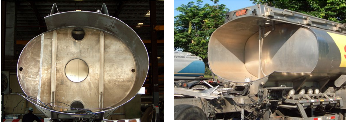
Imagen 12 Vista de interior de tanques de aluminio
