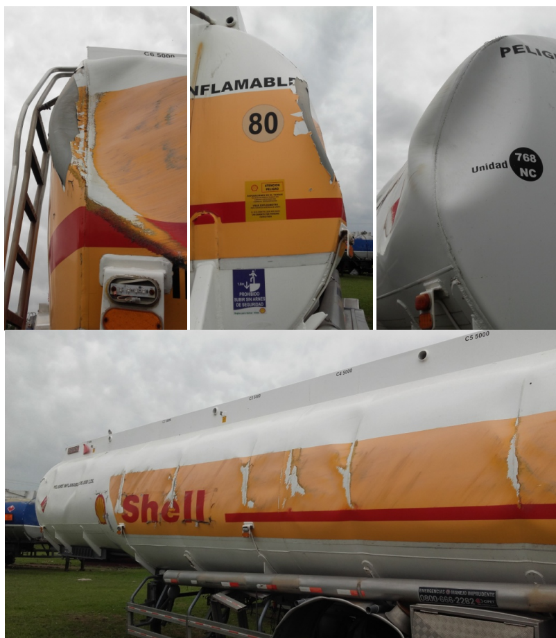
Imagen 4 Vuelco de una unidad en Argentina Transporte de 40.000 litros de gasolina Perdida 0 litros
