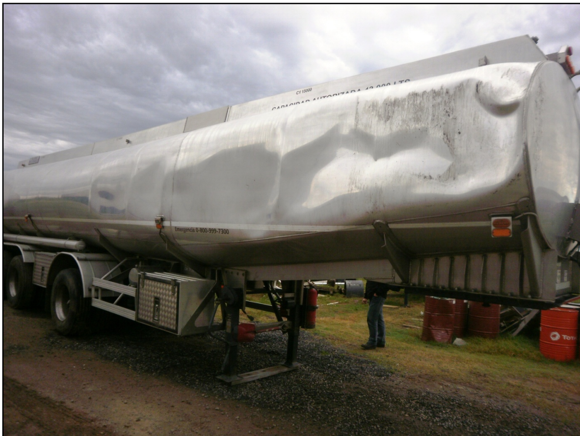
Imagen 2 Vuelco de una unidad en Argentina Transporte de 40.000 litros de gasolina Perdida 0 litros
