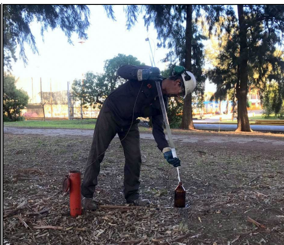
Figura 4. Muestreo de agua subterránea
