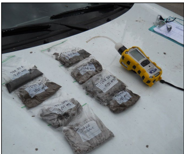
Figura 3. Medición de VOC en muestras de suelo
