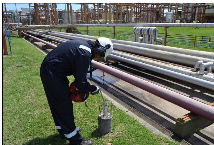
Figura 5. Medición manual de niveles líquidos: profundidad FLNA y agua.
