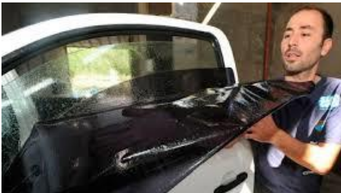
Colocación del Film sobre la cara externa del vidrio
