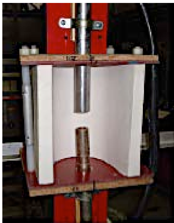
Foto 1 - Caja de ensayo según norma IRAM 3904/04 [3].
