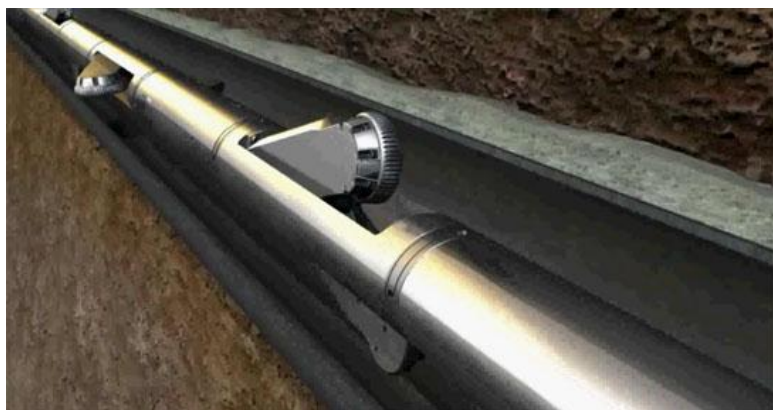
Figura.2 – “Tractor” con sistema de agarre continuo
