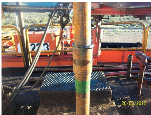
Foto 1. Pipe Dope exudada luego del enrosque de las uniones.
