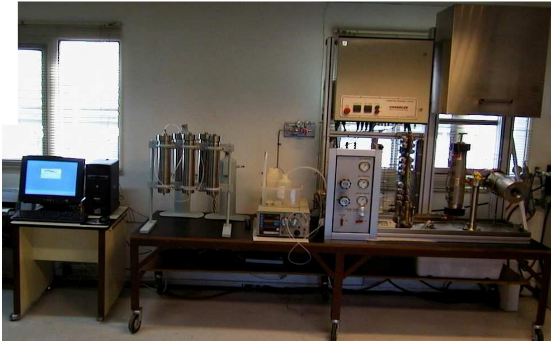
Figura 7. Equipo FRT ( Formation Response Tester ) utilizado para determinar el daño por residuo de polímero a la formación.
