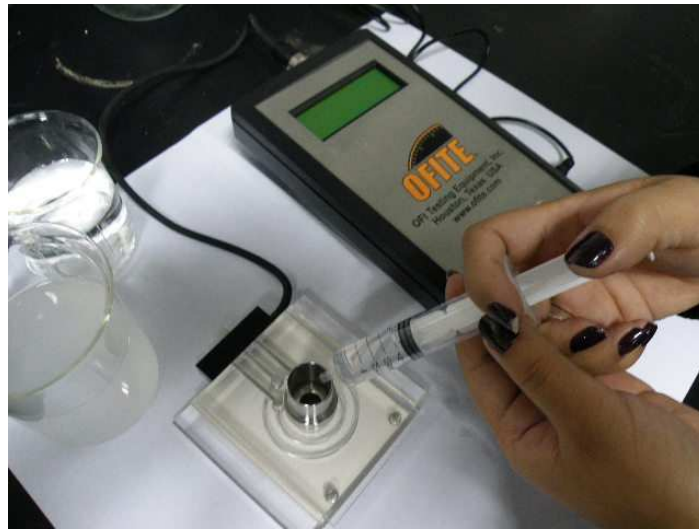
Figura 5. Equipo CST utilizado para la selección del surfactante.
