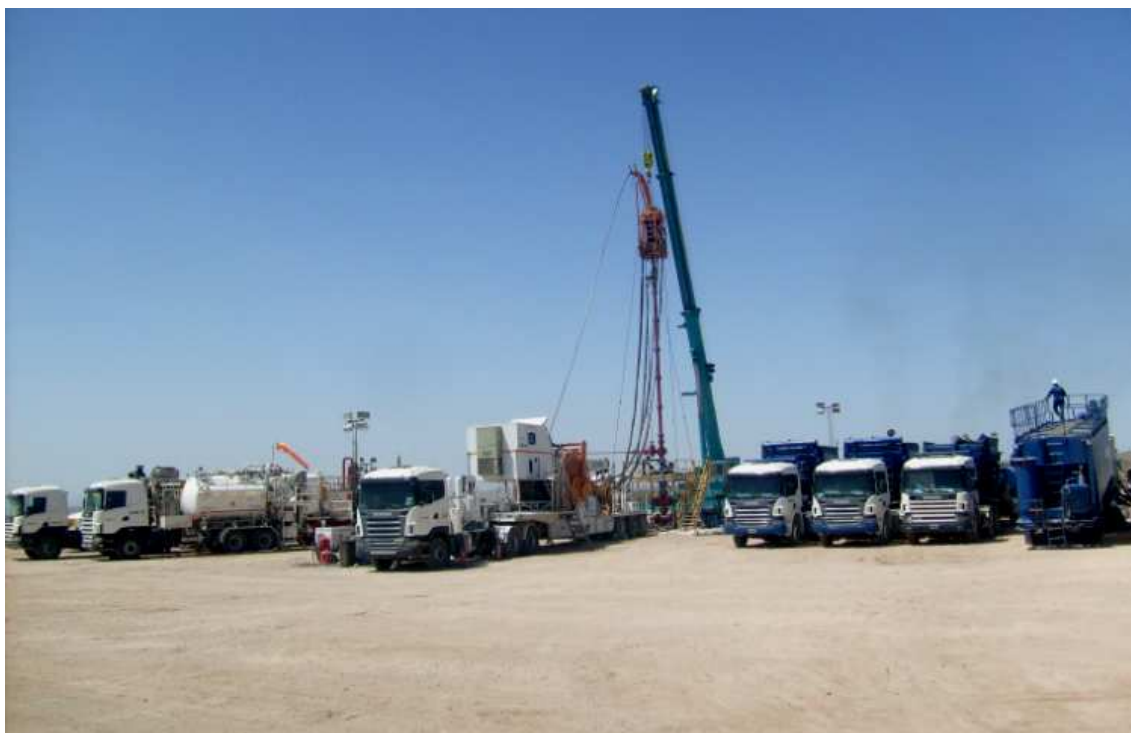
Figura 1. Unidad de CT y equipos periféricos utilizados en la completación del pozo.
