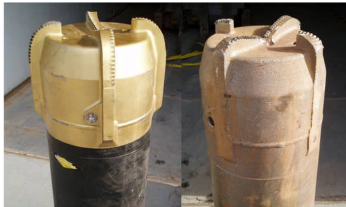
Figura 5: Desgaste de EZCase™ en el Primer Pozo
