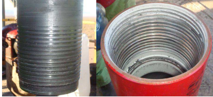
Pin y Cupla Dopeless® luego de un desenrosque
