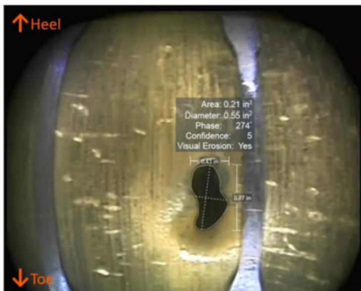
Figura 7. Imagen representativa in situ de punzado erosionado.
