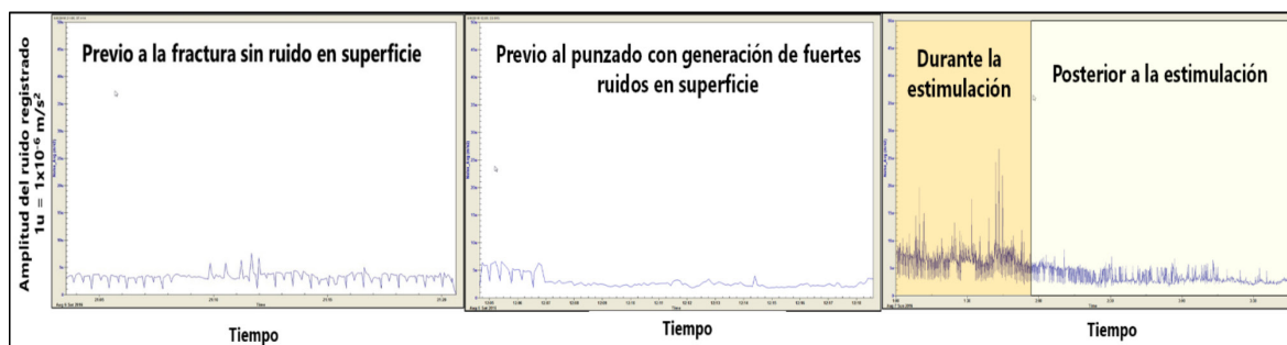
Figura 7. Pruebas de ruido. A) Antes de fractura sin ruidos en superficie. B) Antes del punzado con ruidos en superficie. C) Durante y después de la fractura.
