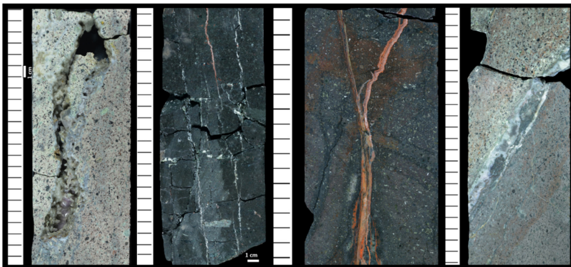
Figura 4. Diferentes fracturas rellenas y parcialmente rellenas y distintos tipos de rellenos observados.
