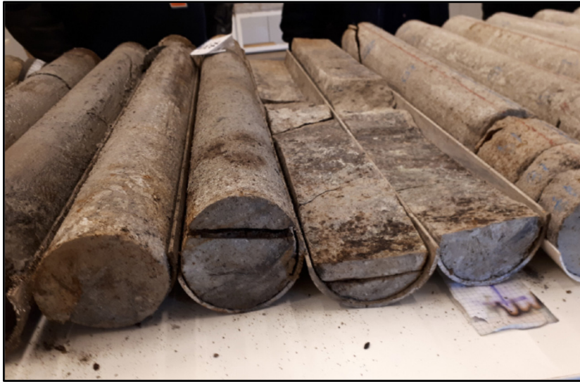
Figura 13. Fracturas térmicas reconocidas en la corona del pozo SM.a-1002 (cada tramo de corona corresponde a un metro de longitud).
