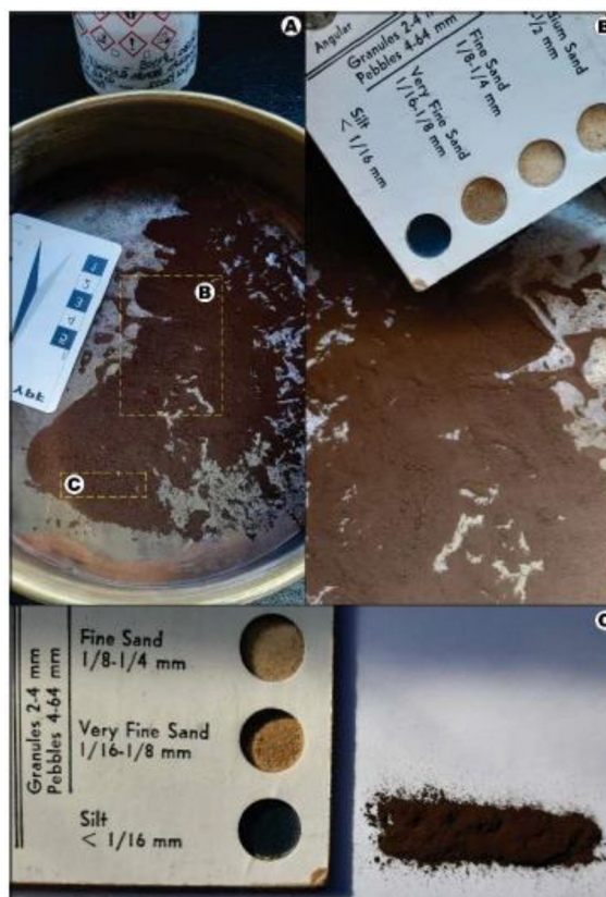
Figura 6. Material resultante del pasante tamiz #200 (0.074 mm) nótese que el material posee una granulometría menor a 0.074 mm (tamaño limo y arcilla)
