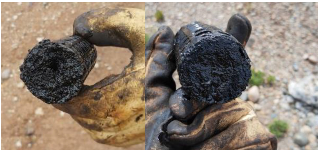
Figura 3. Muestras solidas de los filtros ubicados en el puente de inyección
