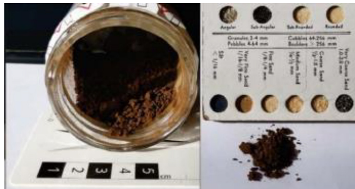
Figura 4 A. Muestra sin tratamiento previo de lavado de hidrocarburos
