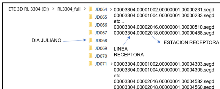
Figura 17. Estructura de la grabación de registros brutos no correlados de 60 segundos por línea receptora.
