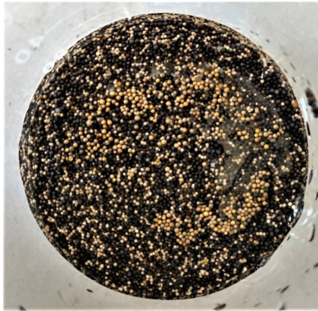
Figura 6. Fotografía de una muestra de agente de sostén (previamente lavada) tomada en el periodo de producción del pozo. Se observan a simple vista los tres tipos de agentes de sostén utilizados en el tratamiento. El agente de sostén oscuro/negro corresponde al cerámico importado #20/40, el claro/beige al cerámico importado #30/50 y el amarillo/ámbar al agente de sostén trazable #20/40.
