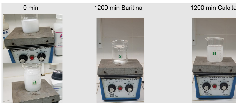
Figura 10. Reacción extendida a 20 horas del producto químico con Baritina y Calcita.
