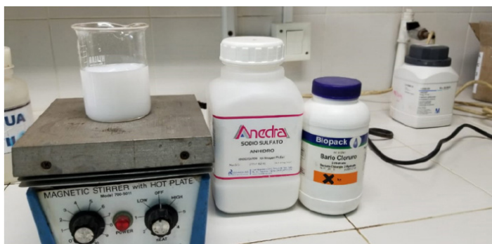
Figura 6. Generación de neo-baritina por precipitación controlada en laboratorio.
