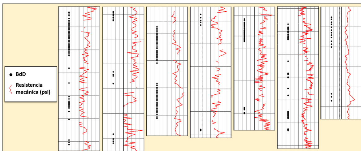
Figura 14. Clusters de BdD en coronas versus geomecánica (resistencia mecánica de la roca, scratch ).
