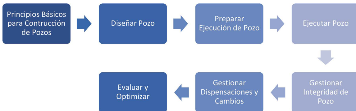
Figura 7. Proceso de Construcción de Pozos
