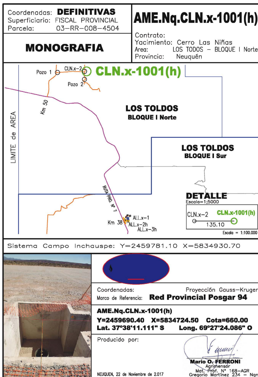
Figura 3. Ejemplo de formato estándar utilizado para las monografías de coordenadas definitivas/provisorias de pozos.
