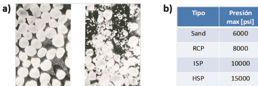
Figura 4. a) Fotografía ejemplificando la rotura de los granos de agente de sostén y generación de finos. b) Valores típicos de resistencia al crushing.
