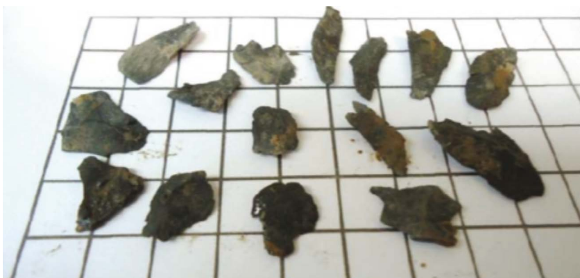
Figura 9. Morfología astillada y tabular producida por alta presión de poro o vibraciones mecánicas.
