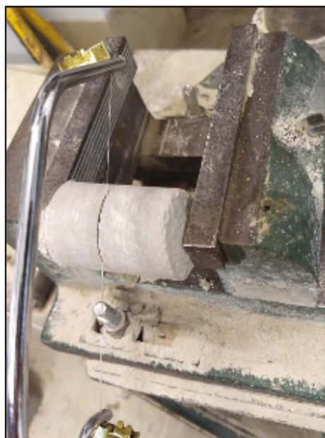
Figura 12. Terminación final de la entalla mediante hilo diamantado (captura propia).
