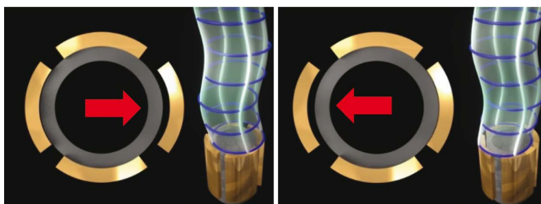
Figura 10. Dipolo mostrando el movimiento de la fuente y la direccionalidad preferencial de la onda generada dentro del pozo. Frecuencia \sim 2 - 3 kHz.
