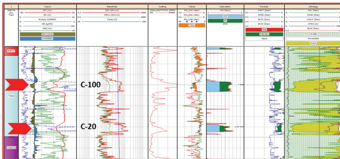
Figura 7. Petrofísica. Capas C-100 y C-20. Nótese en el track 1 la correspondencia entre la curva de SP (color rojo) y GR (color verde) para definir espesor total. El matcheo en los tracks 2 y 3 de la resistividad y la curva de Gas total del control geológico, la Resistividad profunda (color rojo), la Resistividad somera (color verde) y GT (color rojo). El track 4 muestra el ajuste de las porosidades calculadas con el perfil de Densidad (verde) el sónico (rojo) con datos de laboratorio (puntos azules).
