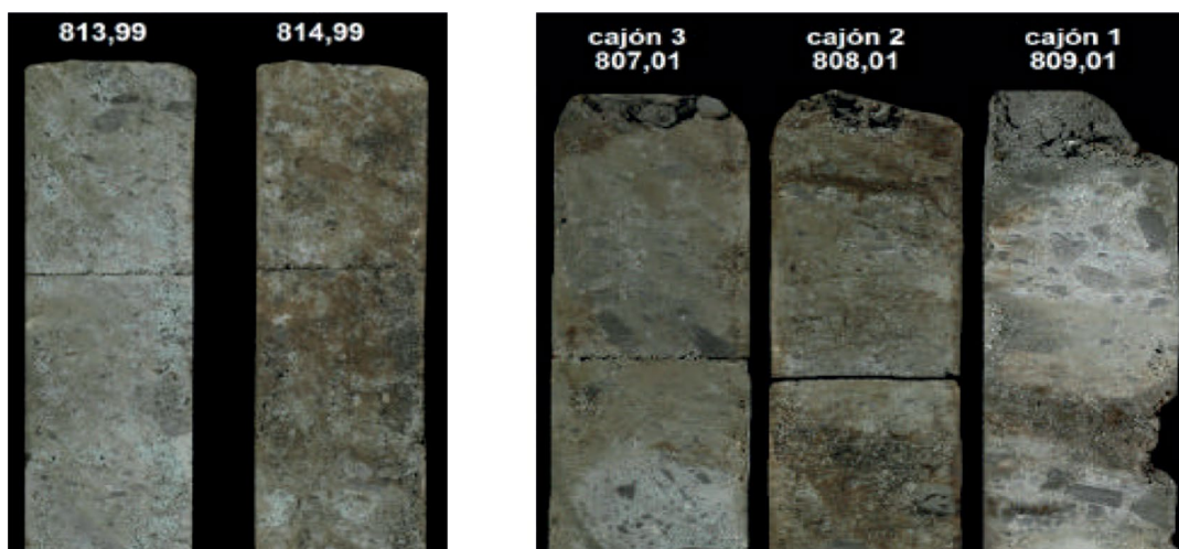
Figura 3. Contenido de arcillas como control de impregnación de hidrocarburos (A) y cemento de calcita como control de la impregnación (B). Detalles de fotografía de corona
