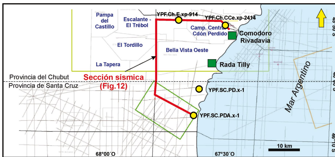
Figura 5. Ubicación de los pozos analizados (círculos amarillos) y sección sísmica interpretada (línea roja), en los extremos sureste de la Provincia del Chubut y noreste de la Provincia de Santa Cruz
