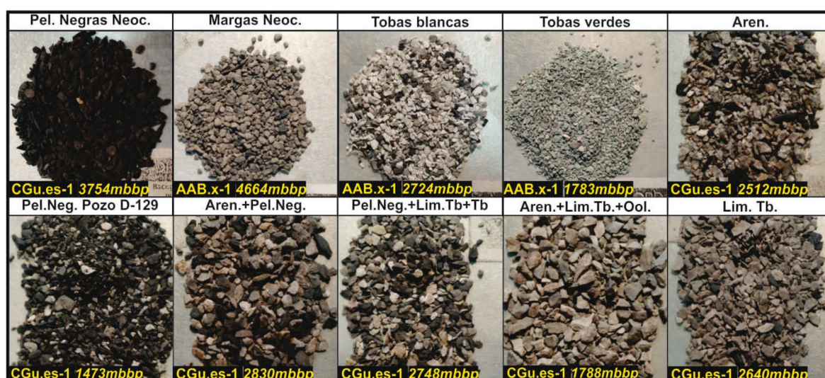
Figura 3. Ejemplos de muestras de cutting sobre las que se midió FRx. Notar que hay distintos grados de pureza, desde muestras con un solo componente litológico hasta recortes con mezcla de tres componentes (Pel.: pelitas, Aren.: areniscas, Lim. Tb.: Limolitas tobáceas, Tb.: Tobas, Ool.: calizas oolíticas)
