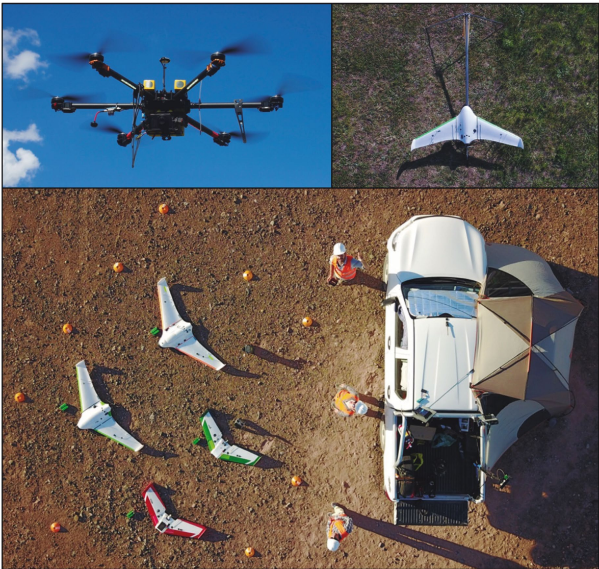
Figura 3. Tipos principales de drones. ARRIBA IZQUIERDA: drone tipo ala rotativa o multirrotor. ARRIBA DERECHA: drone tipo ala fija o avión. ABAJO: drones del tipo ala fija utilizados para relevar los basaltos referidos en este trabajo.
