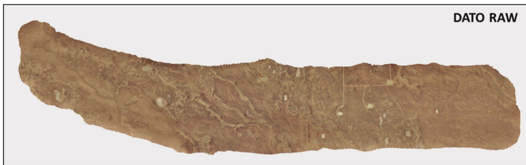
Figura 16 – Ortofotomosaico a partir del dato "RAW" o NIR de la cámara, es decir, sin aplicación de ningún algoritmo.
