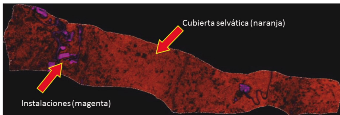
Figura 18. Ortofotomosaico con algoritmo de NDVI aplicado y una escala de colores personalizada que logra diferenciar la vegetación en el tono de anaranjado, cuanto más intenso es su color mejor es su estado de salud vegetal (bajo estrés). El color negro corresponde al sustrato del terreno, es decir, el suelo, carreteras, desmalezamiento y cuerpos de agua. El color magenta corresponde a instalaciones o construcciones en el área.
