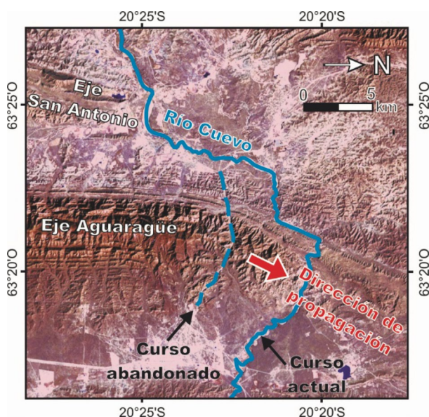
Figura 7. Ejemplo actual de desviación del curso del río Cuevo causada por la propagación de la terminación norte de la Sierra de Aguaraque (ver la figura 1 para la ubicación).
