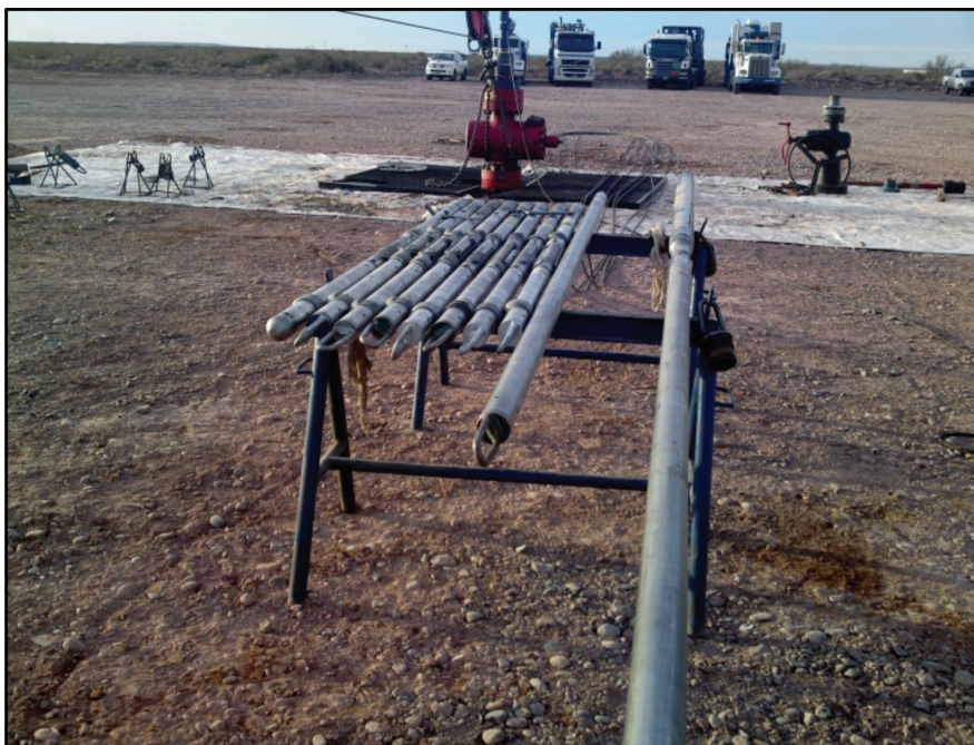
Figura 2. Herramientas que contienen los sensores para detectar las señales microsísmicas.
