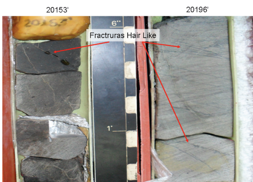
Figura 11. Fracturas tipo cabello ( hair like ) cementadas. El tipo de cemento se determinará por estudio de secciones finas. Estas fracturas afectan negativamente el flujo generando anisotropía.
