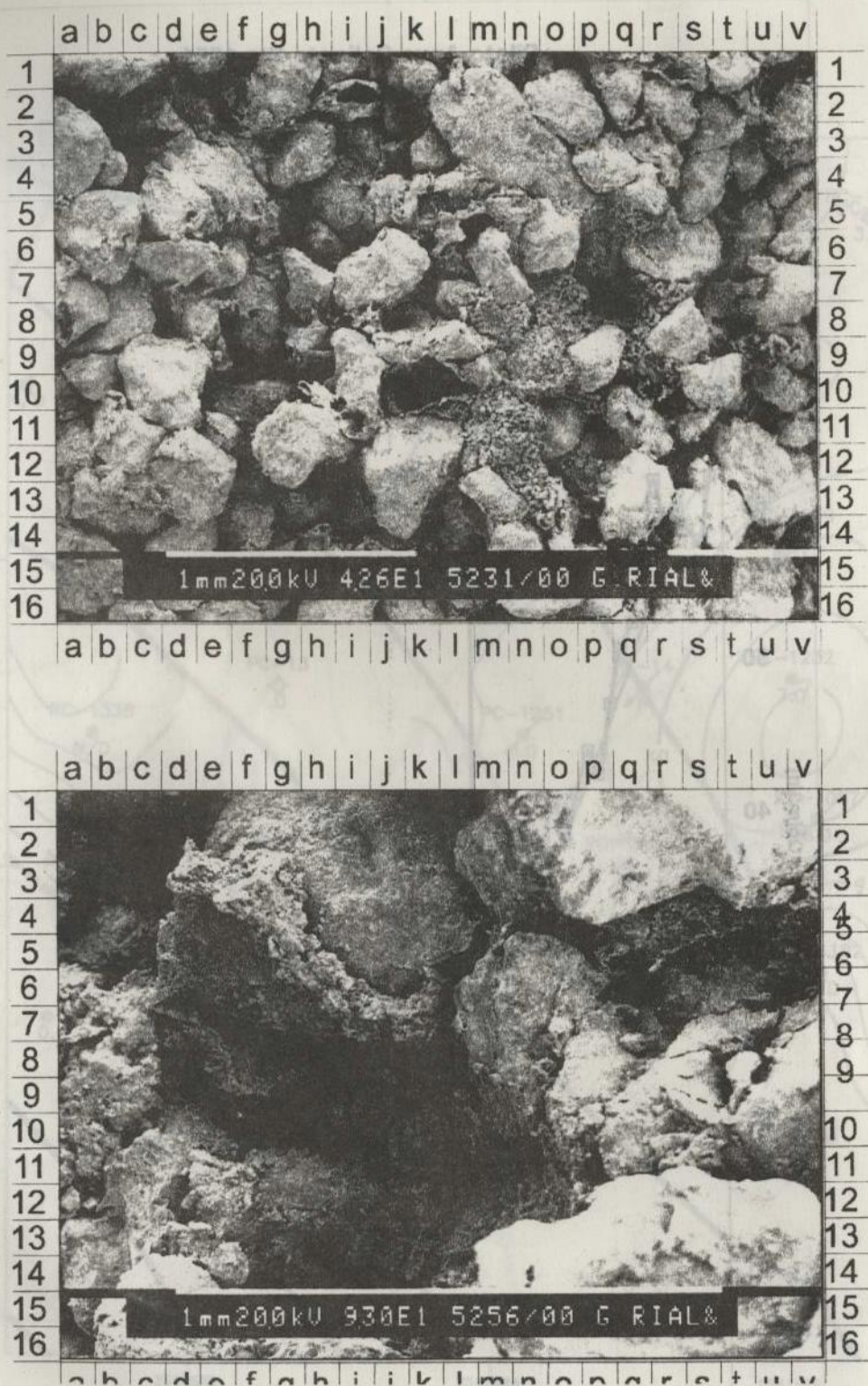
Fig. 13 : Microfotografías de una muestra de alta permeabilidad y detalle del relleno.
