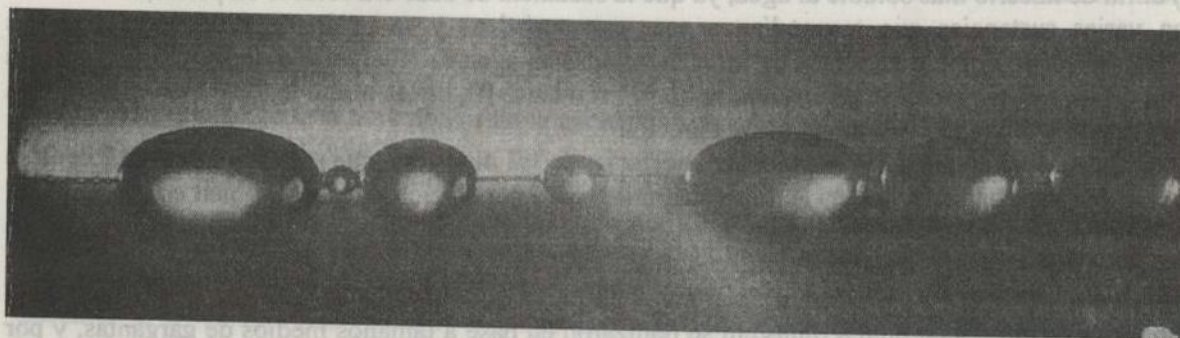
Figura 3: imagen de gotas de petróleo en surfactante en el capilar del tensiómetro de gota rotante.
