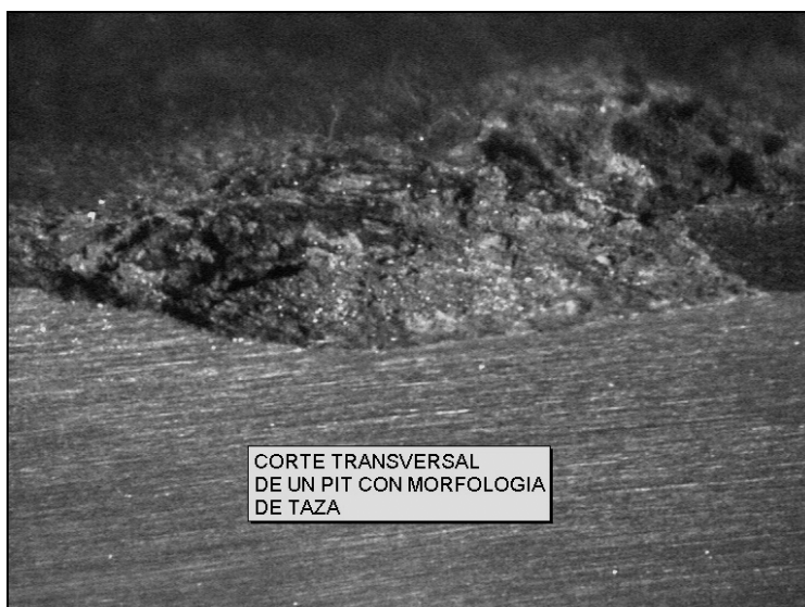
Figura 3 Corte transversal de un pit en forma de taza Donde se puede apreciar progresión hacia el espesor del tubo en forma de escalones
