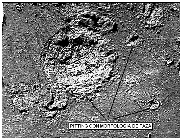
Figura 2 Ataque corrosivo con morfología de picado en forma de taza
