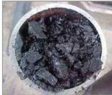
- Ejemplo de roturas de elastómeros en el Yacimiento Diadema
