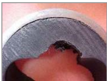
3- Desprendimiento profundo y falta de adherencia a la camisa del estator.
