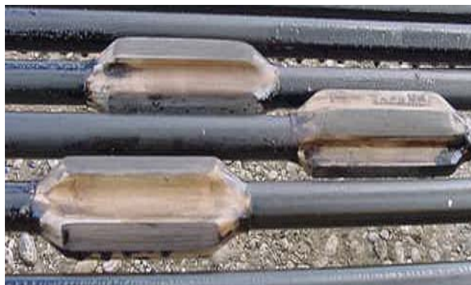
Fig. 2 - ESTADO DE CENTRALIZADORES
