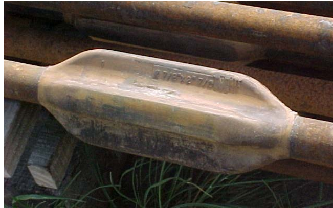
Fig. 3 - ESTADO DE CENTRALIZADORES Varillas con centralizadores en playa de almacen posterior a la inspección no destructiva.
