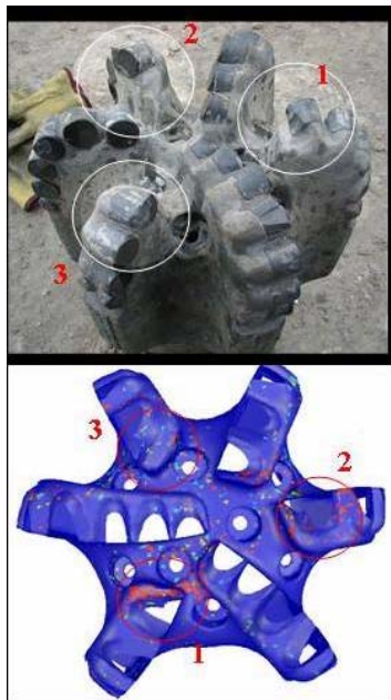
Figure 4 - Comparación de la erosión observada en el Campo con la predicha por el Modelo de la CFD. El color rojo indica altas tasas de erosión.
