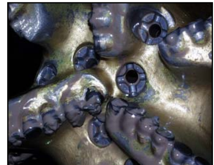
Figura 5 - Comparación de tests de Embolamiento en simulador de Alta Presión
