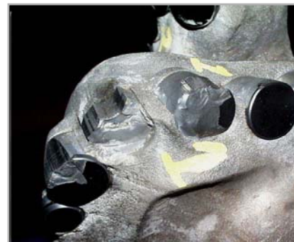
Daño por Impacto
