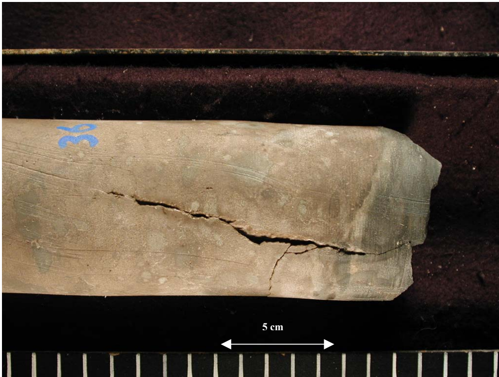
Figura 9. Fractura abierta subvertical en corona de Grupo Pre-Cuyo, pozo LCh.xp-2
