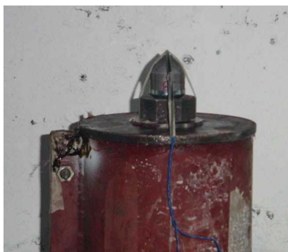
Figura 3. Carga hueca de 22 g ubicada sobre el disco metálico.
