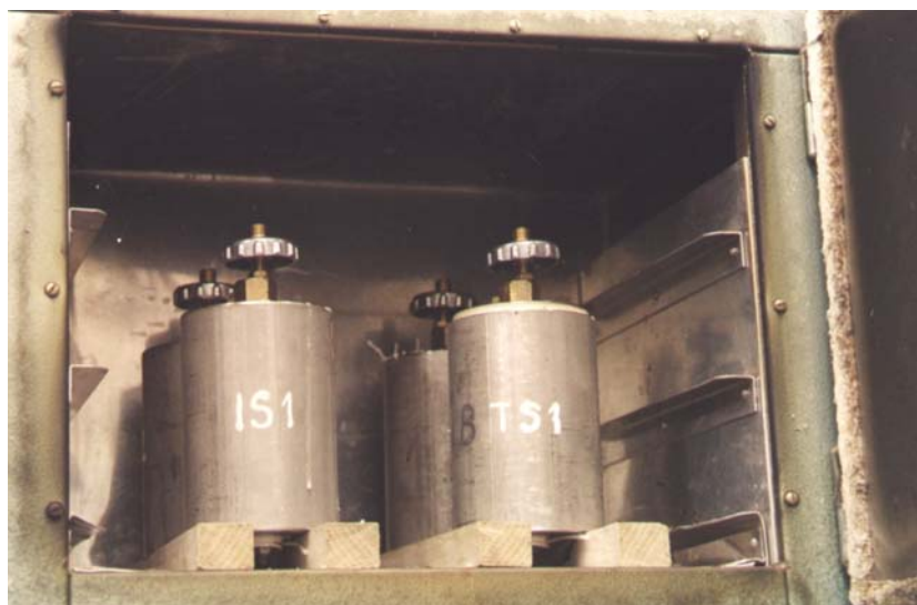
Fotografía 4. Disposición de las celdas en la estufa para ensayos a CFP
