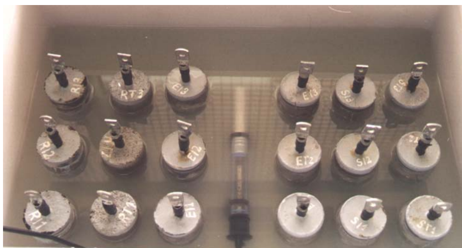
Fotografía 2. Probetas parcialmente inmersas en solución salina (ver tabla 1) a 30 °C (CNS).
