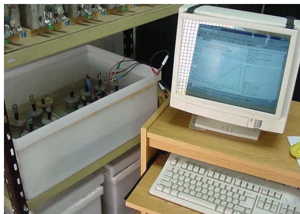
Fotografía 7. Potenciostato empleado para realizar los ensayos de resistencia a la polarización ( R_p ). Probetas expuestas a la condición CNS.
