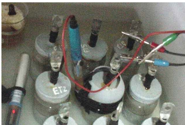
Fotografía 6. Conexión de electrodos a la probeta SI2 expuesta a CNS durante un ensayo de R_p .
