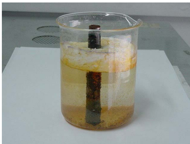
Fotografía 5. Barra de acero directamente expuesta a la solución salina ensayada a 30 °C.
