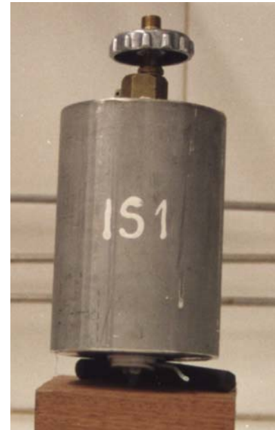
Fotografía 3. Celda IS1 (lechada con inhibidor) empleada para los ensayos en condiciones de fondo de pozo (CFP).
