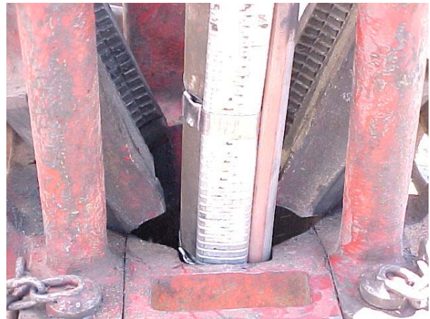
Figura 2 y 3: Prueba de pasaje de tubing, cable de potencia y línea hidráulica a través de la cuña.
