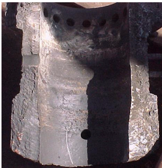
Fig. 6 – Corte longitudinal a cabezal compacto de 20 ¾ x 13 5/8 5M
