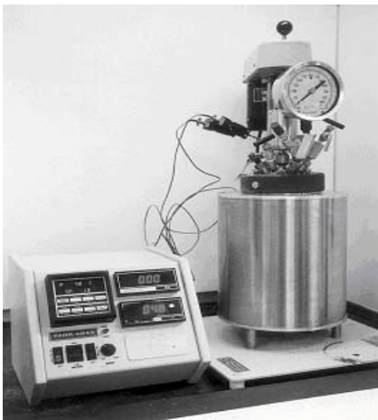
Imagen 2: Equipo de prueba de corrosión de alta presión.
