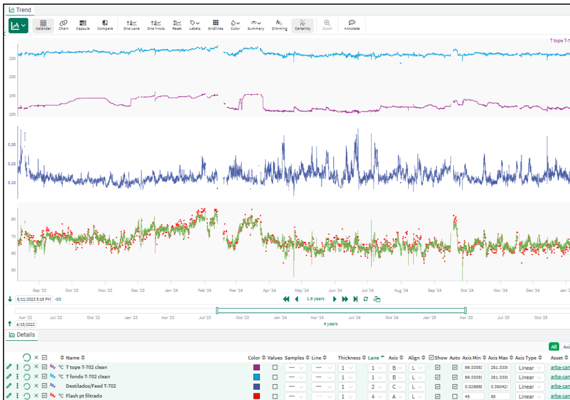
Figura 5. Modelo predictivo en SEEQ para la inferencia del Flash Point del gasoil tratado en la Torre Fraccionadora de la Unidad DHT. Se muestran las variables utilizadas como entradas para el modelo, así como la predicción generada (línea verde) versus valores reales filtrados (puntos rojos).
