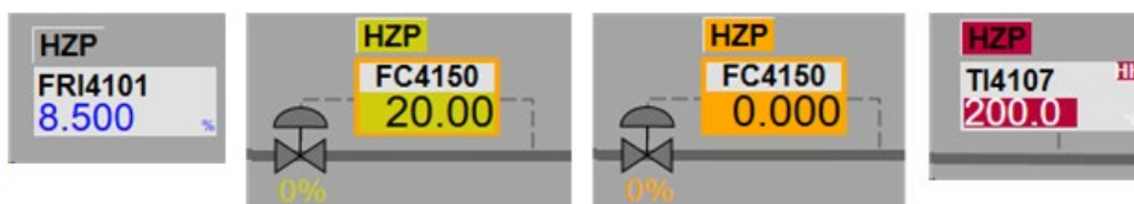
Imagen 4 Ejemplos de indicaciones gráficas en el DCS para alarmas SPS en diferentes estados: sin alarma activa (izquierda) y con alarmas activas de baja prioridad (amarillo), media (naranja) y alta prioridad (rojo). Imagen tomada del simulador del DCS 800xA de la planta de Lubricantes Grupo 1 del Complejo Industrial La Plata.
