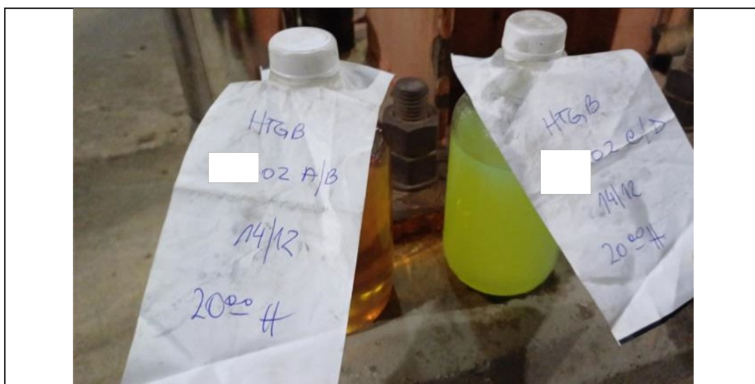
Imagen 6. Muestras de gasoil extraídas de la corriente lado tubos del intercambiador 02-A/B (izquierda) y 02-C/D (derecha). Se observa que la muestra del 02-A/B estaba contaminada.
