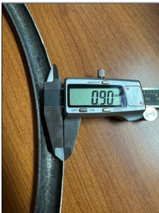
Imagen 11. Espesor de pared del tubo en una de las curvas, en el diámetro externo. El espesor nominal es de 2,11mm.
