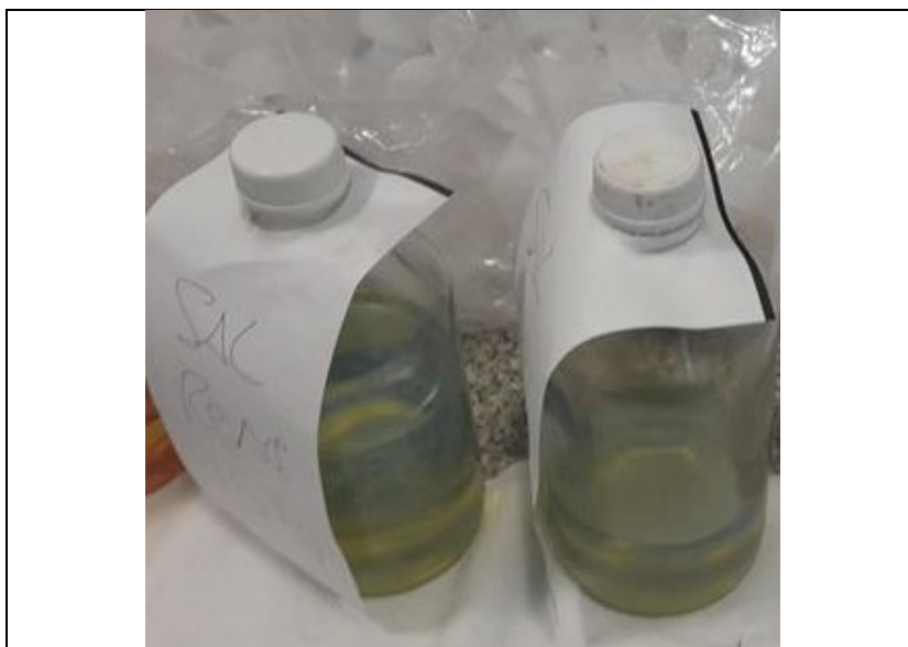
Imagen 5. Coloración de la muestra extraída en el efluente del reactor donde se observa clara y brillante indicando que el reactor estaba operando normalmente.
